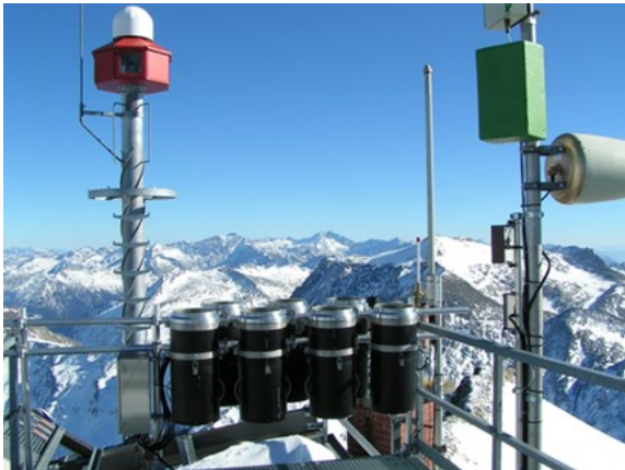
Abb.1: Probensammelgeräte für persistente Schadstoffe am Hohen Sonnblick Fig.1: Sampling Devices for persistent pollutants at Hoher Sonnblick Quelle/Source: Umweltbundesamt/W.Moche
