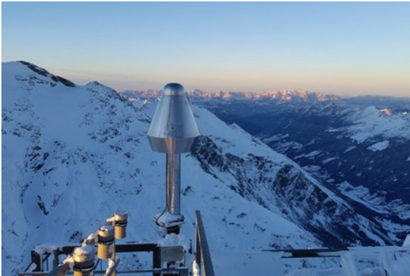
Abb.1: Zentrale Ansaugung für Spurengasmessungen Fig.1: Central sampling manifold for trace gas monitoring Quelle/Source: Umweltbundesamt
