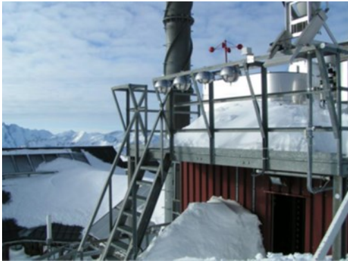
Abb.1: Passive Sammler am Hohen Sonnblick Fig.1: Passive Samplers at „Hoher Sonnblick“ Quelle/Source: Umweltbundesamt/W.Moche
