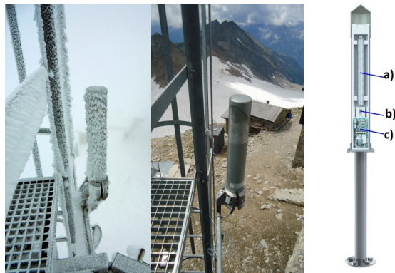
Abb.1: Links: Sonde-Ortsdosisleistung am Sonnblick Observatorium. Rechts: Schema der Sonde mit a) Niederdosiszählrohr, b) Hochdosiszählrohr, c) Auswerteelektronik. Fig.1: Left: Sensor-local dose rate at Sonnblick Observatory. Right: Scheme of the sensor with a Geiger counter für a) low dose rate, b) high dose rate, c) evaluation electronic.
