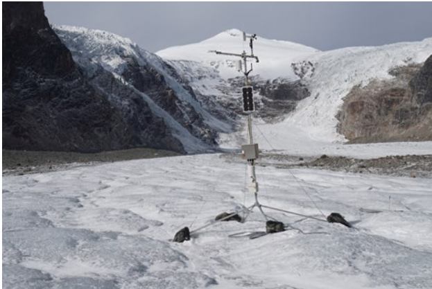
Abb.1: Automatische Wetter- und Massenbilanzstation auf der Pasterze. Fig.1: Automatic weather and mass balance station at Pasterze. Quelle/Source: ZAMG/G. Weyss
