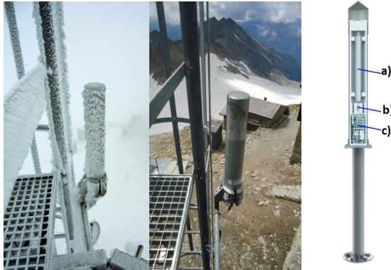
Abb.1: Links: Sonde-Ortsdosisleistung am Sonnblick Observatorium. Rechts: Schema der Sonde mit a) Niederdosiszählrohr, b) Hochdosiszählrohr, c) Auswerteelektronik. Fig.1: Left: Sensor-local dose rate at Sonnblick Observatory. Right: Scheme of the sensor with a Geiger counter für a) low dose rate, b) high dose rate, c) evaluation electronic. Quelle/Source: Foto: GEOSPHERE/SBO/H.Scheer & https://odlinfo.bfs.de/images/uploads/ODL-Messsonde-Info.jpg
