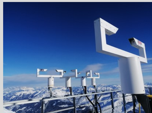
Abb.2: Partile Volume Monitors (SBO, Puy de Dome, Helmos, Schmücke, Milesovka)
