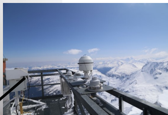
UV-Biometer. Damit misst die Universität BOKU wieviel UV-Licht vorhanden ist. UV kann schädlich für den Menschen sein und zum Beispiel Sonnenbrand auslösen!
