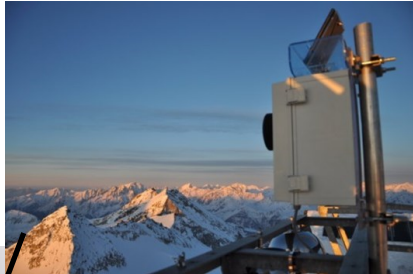
BAT-Detektor: Der nimmt die Rufe der Fledermäuse auf.
