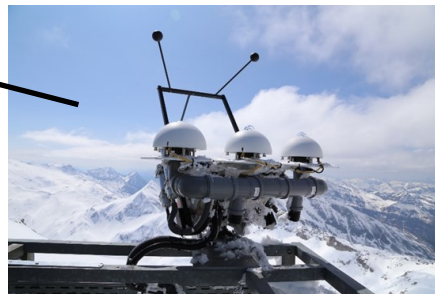
Solar-Tracker. Der verfolgt die Sonne und misst wieviel Sonnenlicht und Energie von der Sonne zum SBO kommt.
