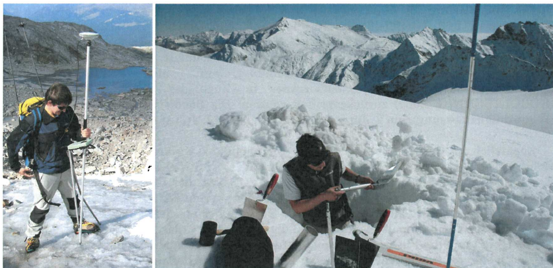
Abbildung 9: Wolfgang Schöner beim Einmessen eines Ablationspegels auf der Zunge des Goldbergkeeses mittels RTK-GPS am 7.9.05 und Daniel Binder beim Graben eines Schneeprofiles am obersten Teil des Goldbergkeeses am 12.10.05
