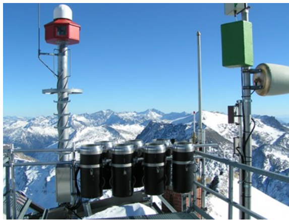
Abb.1: Probensammelgeräte für persistente Schadstoffe am Hoher Sonnblick Fig.1: Sampling Devices for persistent pollutants at Hoher Sonnblick Quelle/Source: Umweltbundesamt/W.Moche
