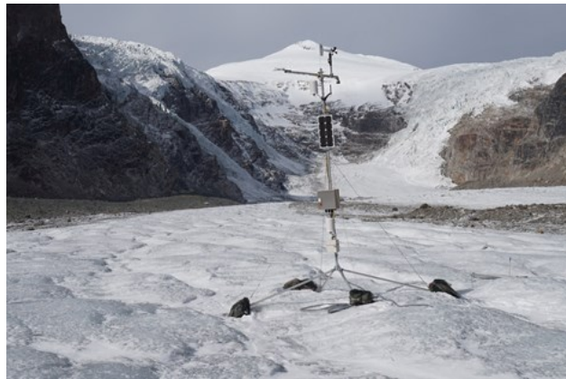
Abb.1: Automatische Energie- und Massenbilanzstation auf der Pasterze Fig.1: Automatic energy and mass balance station at Pasterze Quelle/Source: G. Weyss
