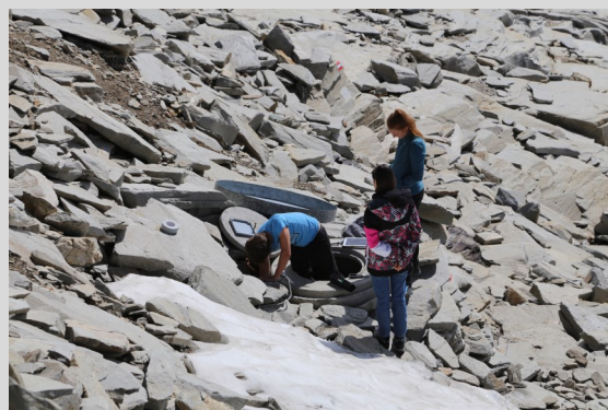
Abb.2: Wartung der Permafrostmessketten in den 20m Bohrlöchern am Hohen Sonnblick im Rahmen von ASBO und Schulung von Praktikantinnen. Fig.2: Maintenance of the permafrost electrodes in the 20m boreholes at Mt. Hoher Sonnblick within ASBO and training of interns.
