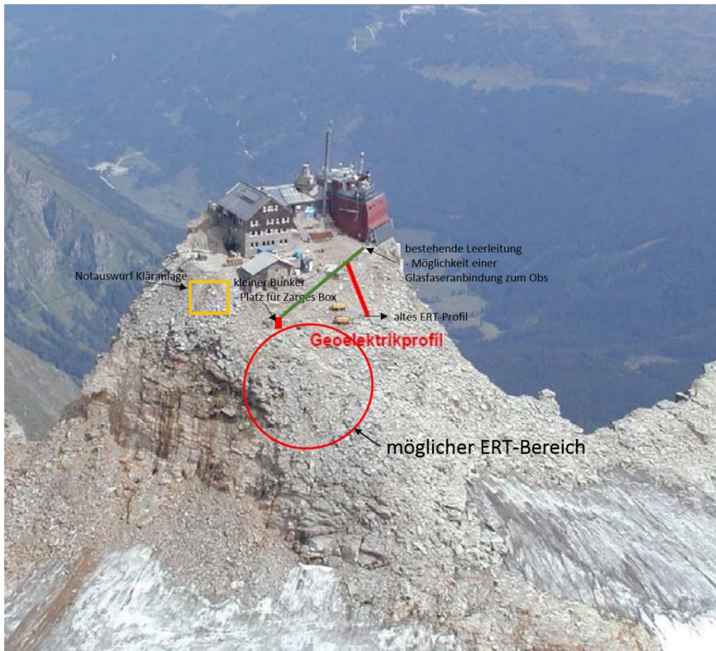
Abbildung 72: Lage des ERT-Profiles im Jahr 2006 sowie des geplanten ERT-Profiles im Jahr 2015 (Foto: S. Reisenhofer).
