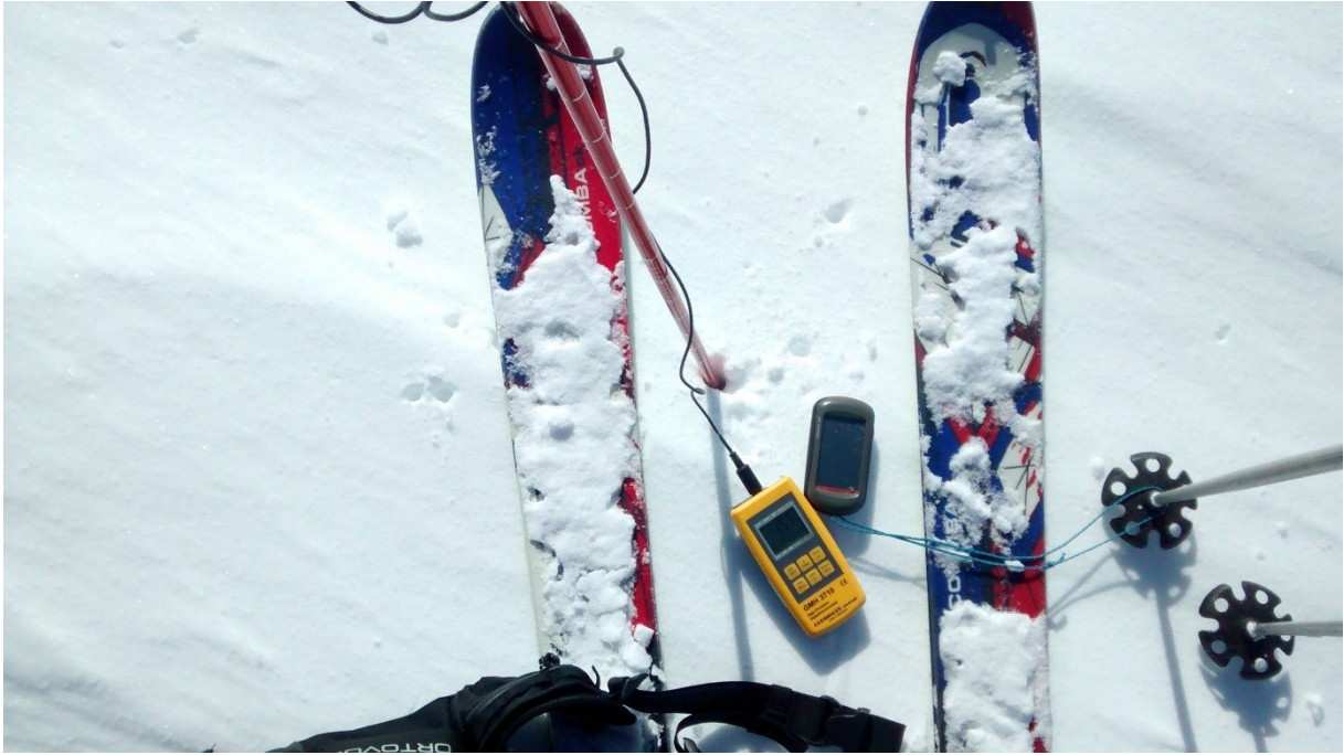
Abbildung 70: Messequipment für die BTS-Messungen – modifizierte Lawinensonde mit eingebautem Temperatursensor und Anzeigegerät sowie ein GPS-Handgerät für die Erfassung der Standortkoordinaten.-
