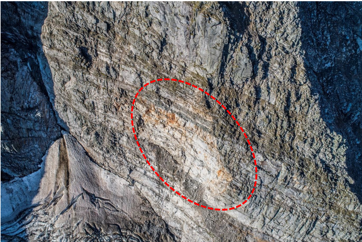
Abbildung 12: Die Ablösebereiche der Felsstürze vom 30.08.2020 und 05.10.2021 (rot markiert) heben sich auf Grund ihrer Helligkeit deutlich von der umgebenden Felswand ab (Foto: UAV-Befliegung vom 25.08.2022).
