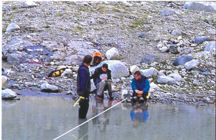
Messung des Strömungsprofils im Pegelquerschnitt
