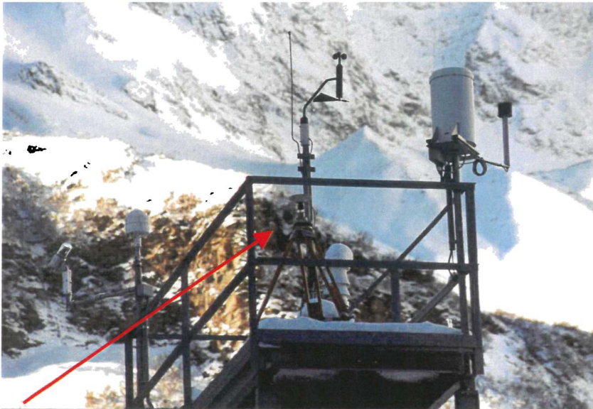
GPS-Antenne auf der Messplattform der automatischen Wetterstation Kolm-Saigurn (Foto Elisabeth Fragner)
