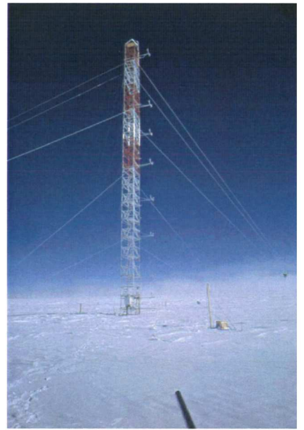
Abb. 6: Auf dem 32 m hohen Messturm wurden Windrichtung, Windstärke und Temperatur in 10 Niveaus gemessen.
