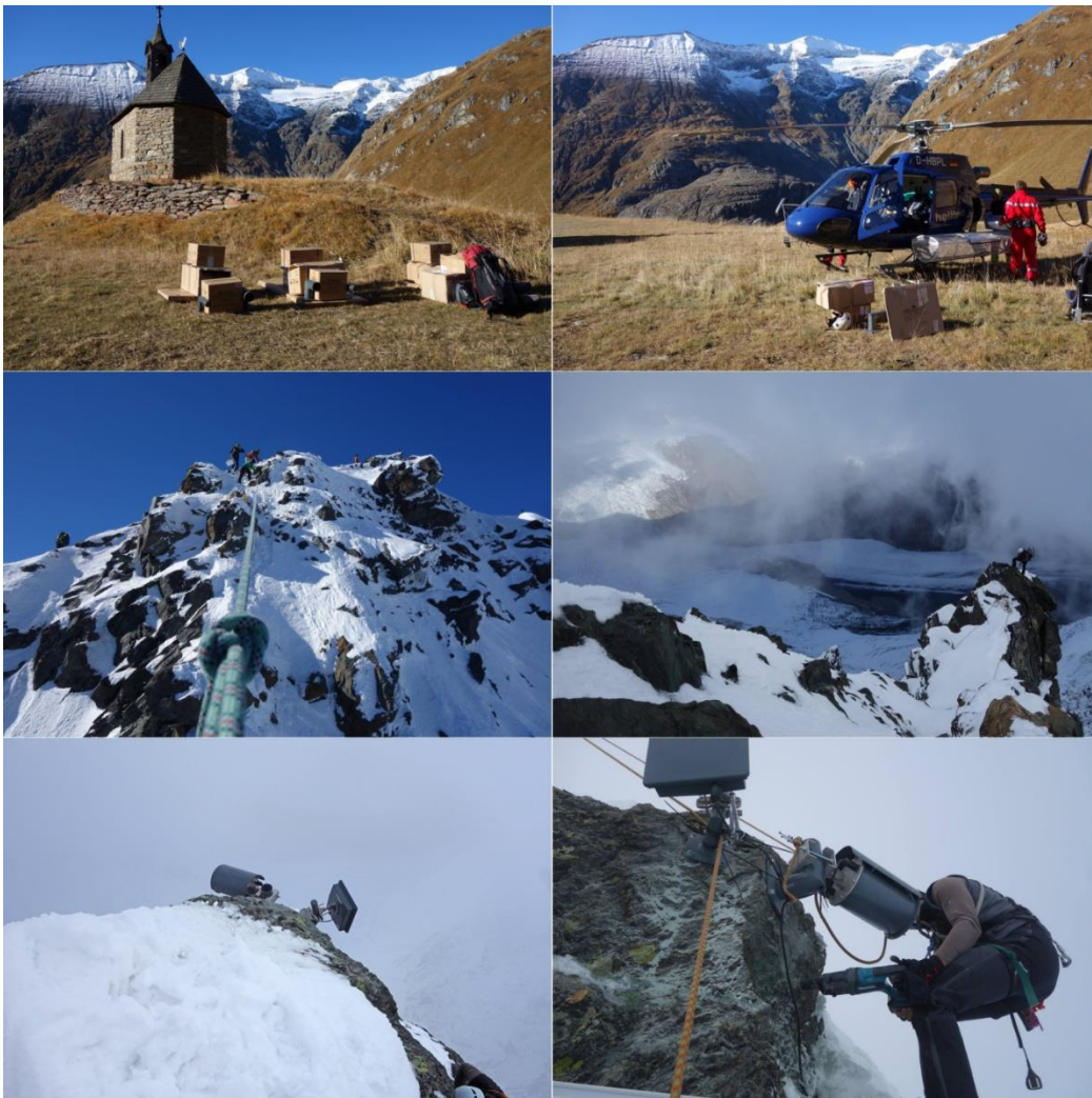
Abbildungen: Oben: Die autarke Webcam am Freiwanddeck (Pasterze) bestehend aus Solarpanel, Richtfunkantenne, Kameragehäuse mit Kamera und Steuerung und Schaltschrank mit Laderegler und Akku. Unten: Fotos von der Montage der höchstgelegenen automatischen Kamera Österreichs, ca. 50m unterhalb des Gipfels des Großglockners.
