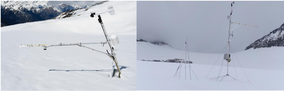
Abbildung: Links die alte eingeschneite Station am 24.04.2018 und rechts die neu Station mit der temporären Schneehöhenmessung am 30.06.2018 (Fotos: Gernot Weyss).
