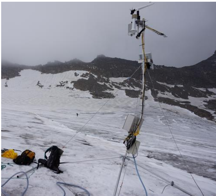
Abbildung: EMBS Kleinfleißkees inklusive des montierten Ausgleichbehälters des automatischen Ablationspegels (09.08.2016) (Foto: G. Weyss).
