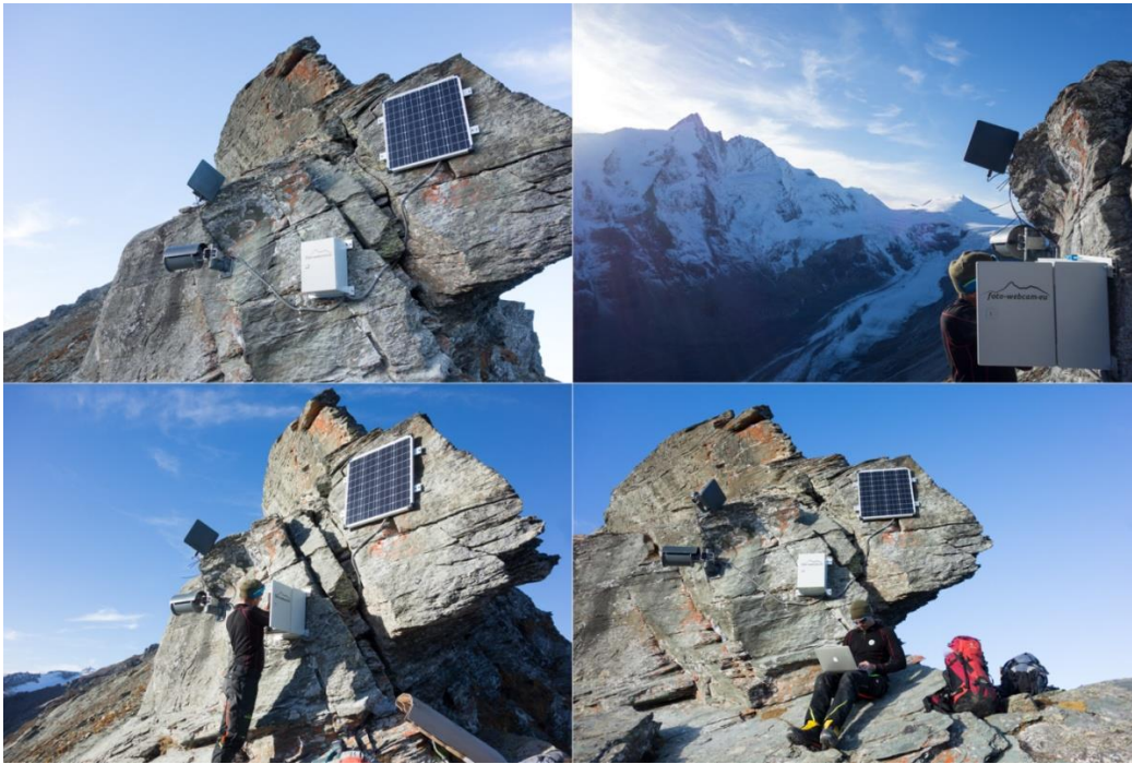
Abbildungen: Oben: Die autarke Webcam am Freiwanddeck (Pasterze) bestehend aus Solarpanel, Richtfunkantenne, Kameragehäuse mit Kamera und Steuerung und Schaltschrank mit Laderegler und Akku. Unten: Fotos von der Montage der höchstgelegenen automatischen Kamera Österreichs, ca. 50m unterhalb des Gipfels des Großglockners.
