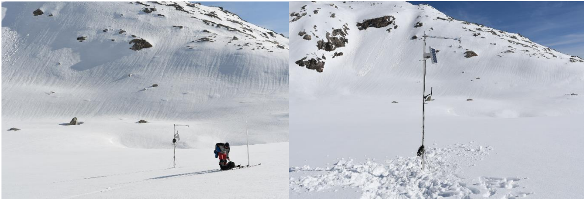
Abbildung oben: Vor und nach der Mastverlängerung am 30.03.2017 der Massenbilanzstation am Goldbergkees (Fotos: G. Weyss).
