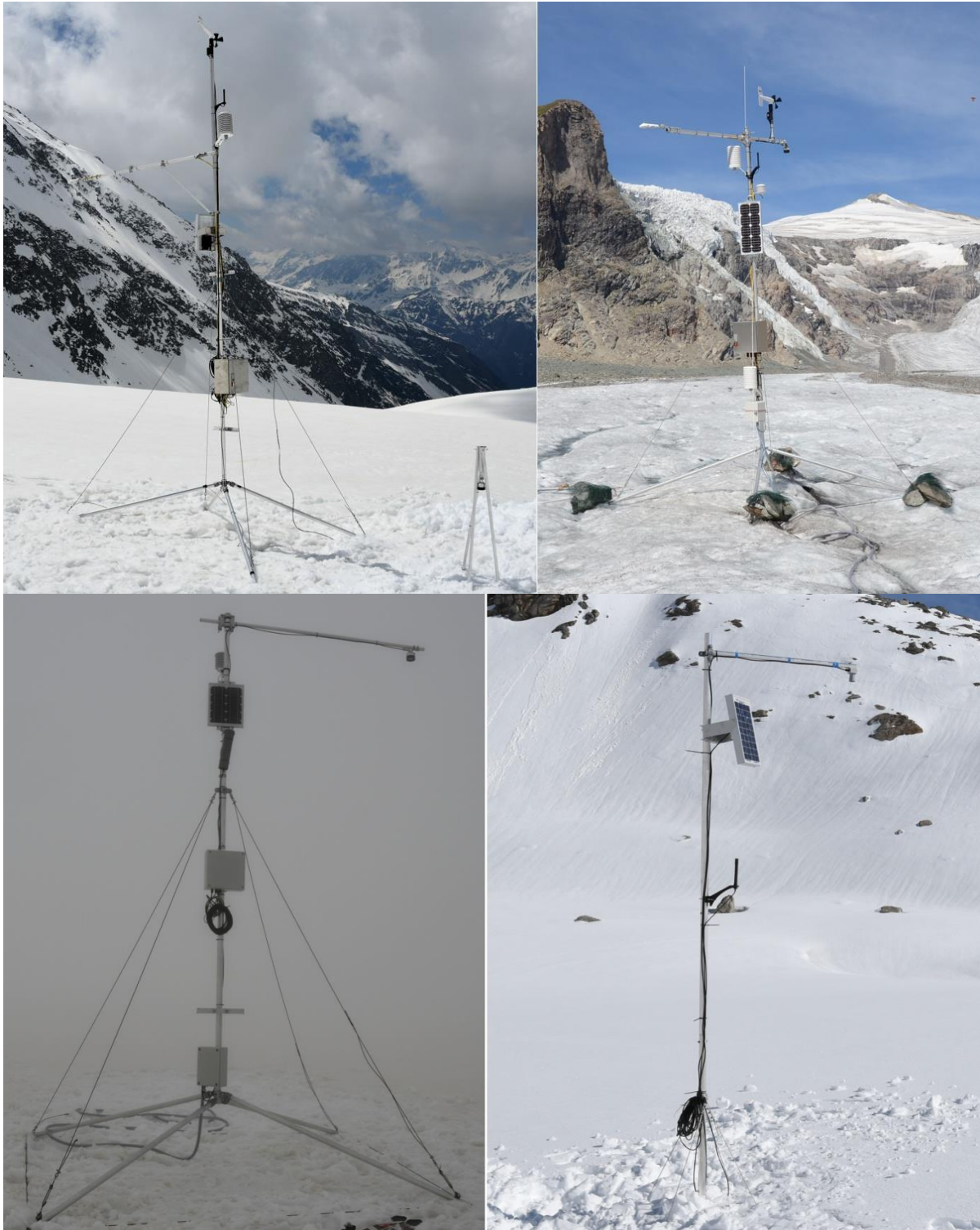
Abbildung: Fotos der Energie- und Massenbilanzstationen (EMBS, oben links: FLK, oben rechts: PAS) und der Massenbilanzstationen (MBS, unten links: PAS oberer Boden, GOK). An allen 4 Stationen werden die Schneehöhe mittels Ultraschall und die Eisablation mit einem im Eis eingebohren Drucksensor, der mit einem Wasserschlauch mit der Station verbunden ist, gemessen. An den Energiebilanzstationen wird zusätzlich die gesamte Meteorologie gemessen, sodass der Energieaustausch an der Grenzschicht zwischen Atmosphäre und Gletscheroberfläche berechnet werden kann.
