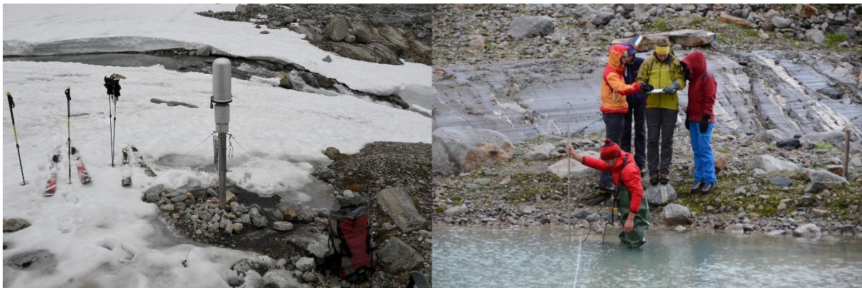
Abbildung: Inbetriebnahme des Abflusspegels am Goldbergbach am 14.06.2017 (links) und Abflussmessung zur Erstellung der Pegelschlüsselkurve am 20.08.2014(rechts) (Fotos: G. Weyss).
