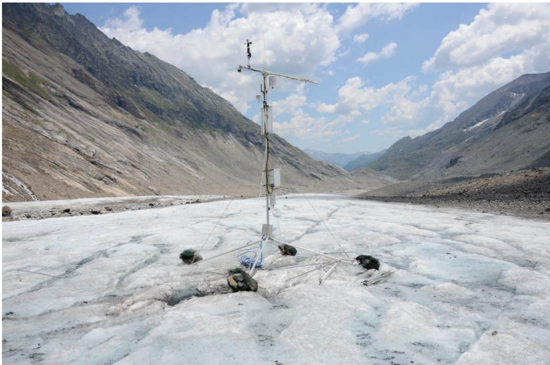
Abbildung: EMBS Pasterze am 04.07.2015 mit montierten automatischen Ablationssensor (Foto G. Weyss).
