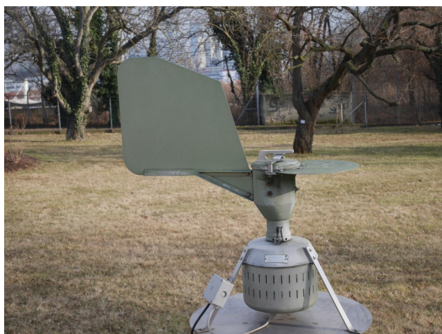
Burkard Pollenfalle im Garten der ZAMG in Wien, betrieben vom österreichischen Pollenwarndienst Burkard pollen trap in the ZAMG - garden in Vienna, operated by the Austrian Pollenwarndienst Quelle/Source: H. Scheifinger
