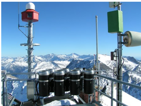
Probensammelgeräte für persistente Schadstoffe am Hoher Sonnblick Sampling Devices for persistent pollutants at Hoher Sonnblick Quelle/Source: Umweltbundesamt/W.Moche
