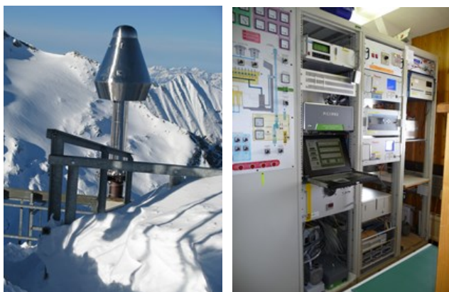
Zentrale Ansaugung (links) und Messgeräte (rechts) central sampling manifold (left) and monitors (right) Quelle/Source: Umweltbundesamt/F. Zimmerl & M. Fröhlich
