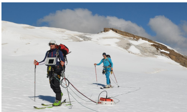
Akkumulationsmessung auf der Pasterze. Accumulation measurements using ground penetrating radar. Quelle/Source: G. Weyss
