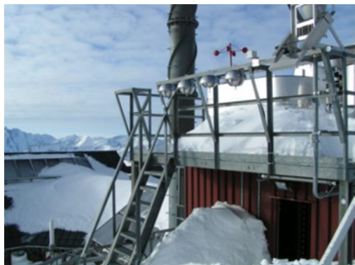
Passive Samplers at „Hoher Sonnblick“ Quelle/Source: Umweltbundesamt/W.Moche
