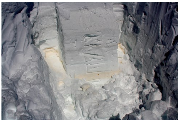
Schneedeckenuntersuchung und Stabilitätstests mit ausgeprägtem Saharastaub Snowpack investigation and stability tests with distinctive Sahara dust layer Quelle/Source: M. Daxbacher
