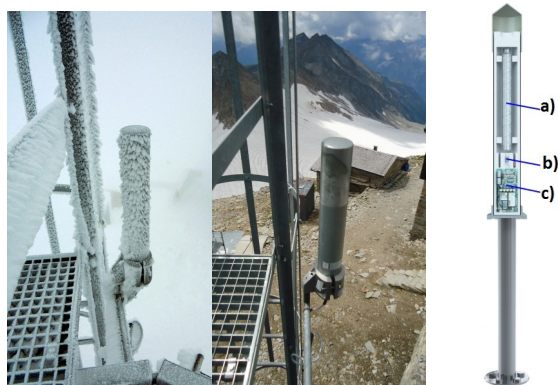
Abb./Fig.01: Links: Sonde-Ortsdosisleistung am Sonnblick Observatorium, Foto@H.Scheer Rechts: Schema der Sonde mit a) Niederdosiszählrohr, b) Hochdosiszählrohr, c) Auswerteelektronik. Quelle: https://odlinfo.bfs.de/images/uploads/ODL-Messsonde-Info.jpg Left: Sensor-local dose rate at Sonnblick Observatory, photo@H.Scheer Right: Scheme of the sensor with a Geiger counter für a) low dose rate, b) high dose rate, c) evaluation electronic. Source: https://odlinfo.bfs.de/images/uploads/ODL-Messsonde-Info.jpg
