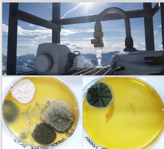
Figure 2, oben: Airsampler am Sonnblick. Links: Filtertechnik (Sartorius, Airport MD8), rechts: Impaktorbesammlung von Bioaerosolen (Bertin, Coriolis µ). Unten: Aktiv wachsende Pilze aus der Luft (SBO). Quelle: Nora Els Caption, upper panel: Various air sampling techniques via filter collection (Sartorius, Airport MD8), left) and impactor method (Bertin, Coriolis µ, right). Lower panel: active fungi collected from Sonnblick air. Source: Nora Els
