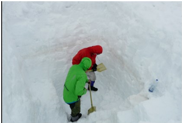
Schneeprofil 2016 am Sonnblick (360 cm) mit markanter Sahara-Staub-Schicht. Snow profile 2016 on Sonnblick (360 cm) with prominent Saharan dust event layer. Quelle/Source: K. Hürkamp
