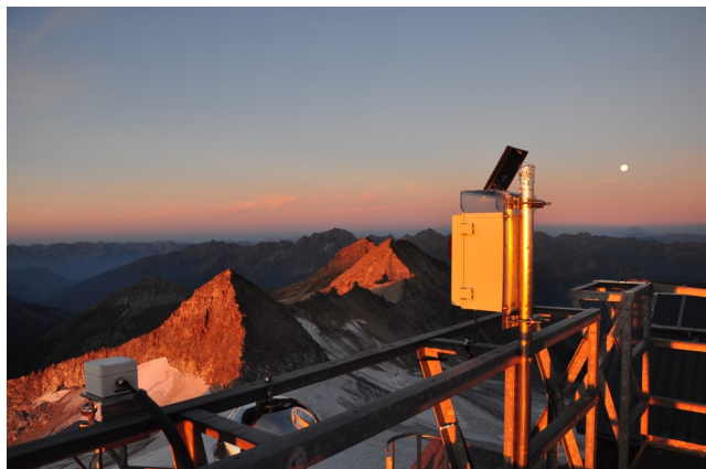
Der Batcorder zeichnet automatisch Ultraschallrufe von Fledermäusen auf The Batcorder: automated recording of ultrasonic bat calls Quelle/Source: K. Widerin
