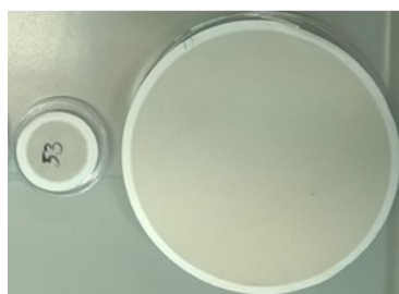
Filter links und linker blauer Balken: Hintergrundaerosol (wenig Masse, geringe Anzahl der ‚groben Teilchen‘, höhere Anzahl der ‚feinen Teilchen‘)
