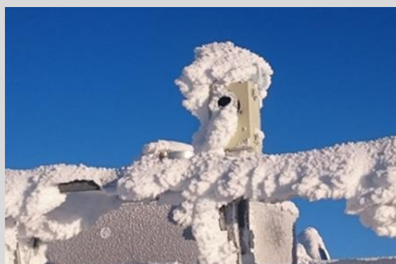
Abb.2: Schwierige Bedingungen für den Ultraschall-Detektor am Sonnblick Observatorium Fig.2: Bad conditions for the ultrasonic-microphone of the „batcorder“
