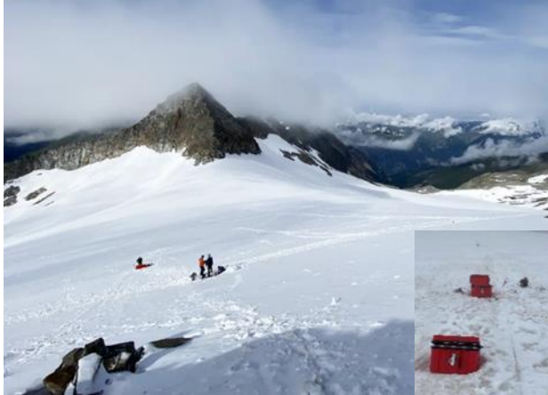
Abb.1: HFIP-Messung am Goldbergkees-Gletscher am Hohen Sonnblick. Inset: Feldaufbau der Chameleon II (Radic Research).
