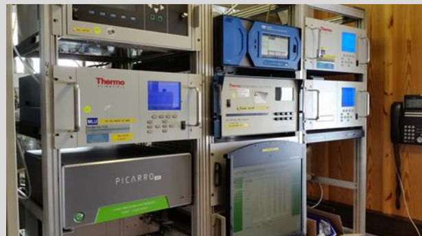
Abb.2: Messgeräte für Spurengase Fig.2: Monitoring devices for trace gases Quelle/Source: Umweltbundesamt
