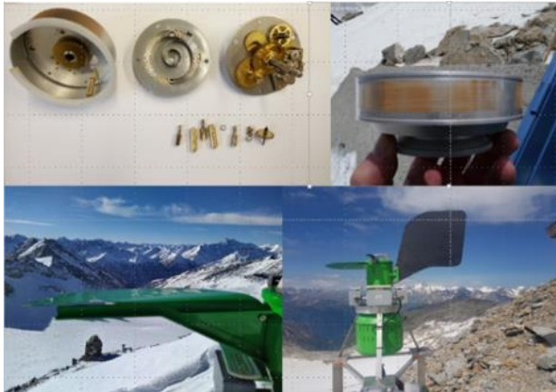
Abb.1: Uhrwerk der Pollenfalle zerlegt, Saharastaub auf der Trommel, die umgeknickte und reparierte Windfahne Fig.1: Disassembled clockwork of the pollen trap, Sahara dust on the drum, the bent and repaired windvane Quelle/Source:Sonnblick
