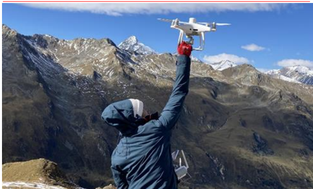
Abb.1: Vermessung der Gletscheroberfläche mit der dji Phantom 4 RTK Fig.1: UAV survey of the glacier surface using a dji Phantom 4 RTK Quelle/Source: Anton Neureiter
