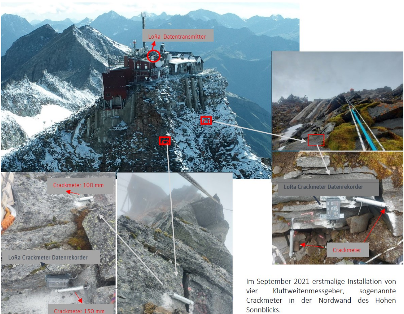
Abbildung 31 Lage der Crackmetermessstellen C1 und C2 sowie die Position des LoRa Datentransmitters auf der Messterrasse des Observatoriums.
