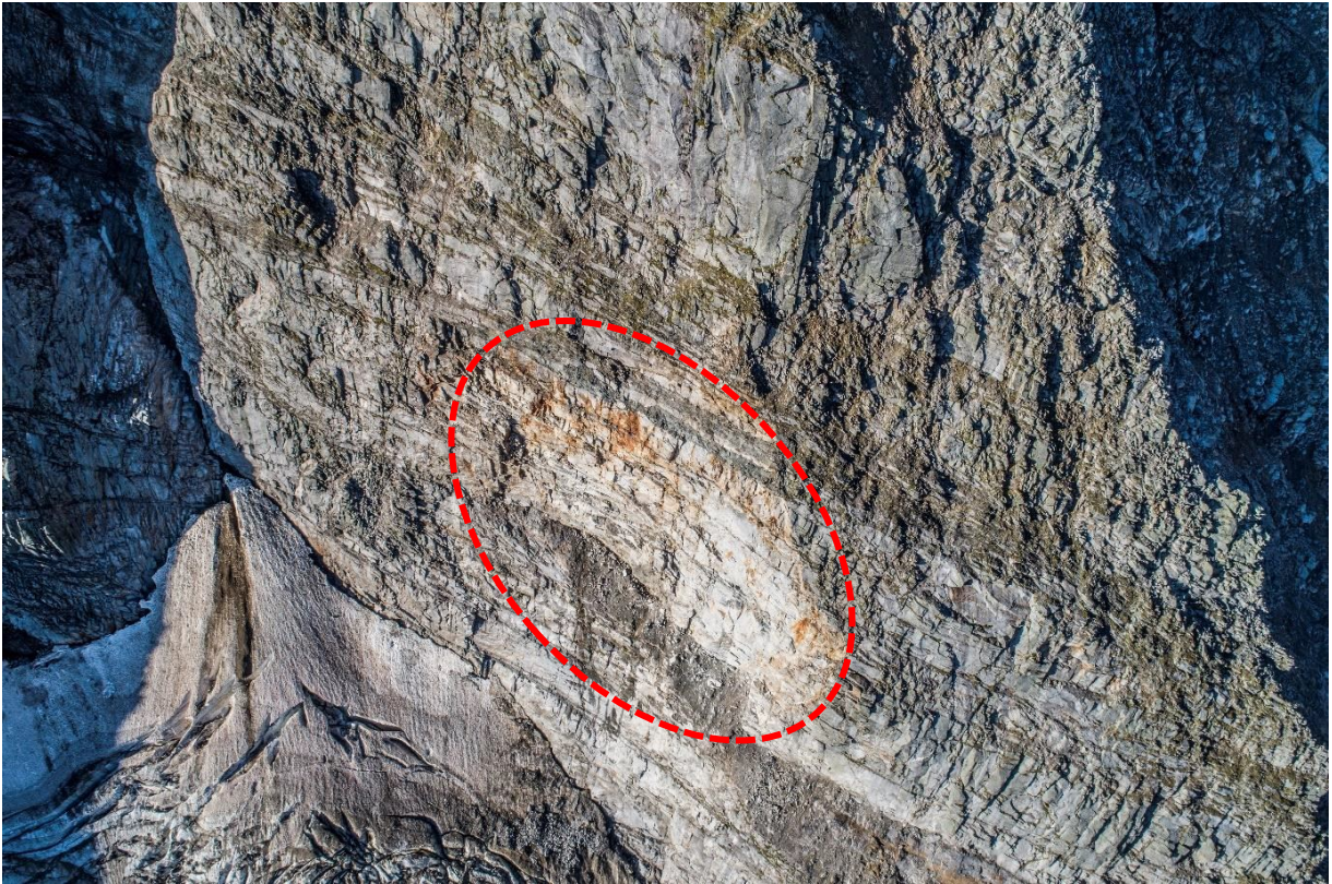
Abbildung 19: Die Ablösebereiche der Felsstürze vom 30.08.2020 und 05.10.2021 (rot markiert) heben sich auf Grund ihrer Helligkeit deutlich von der umgebenden Felswand ab (Foto: UAV-Befliegung vom 25.08.2022).
