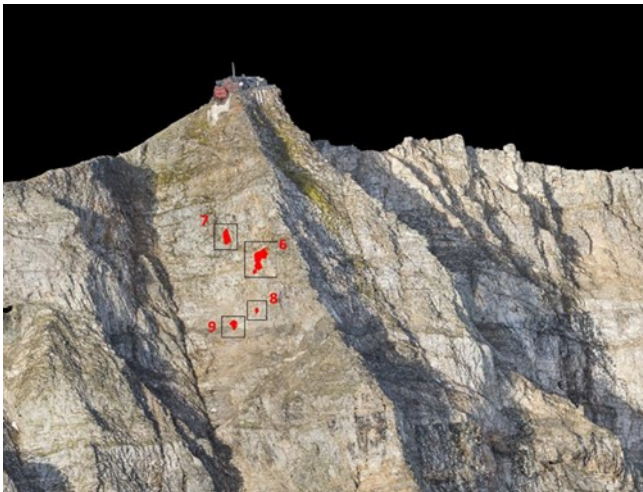
Abb.3: In der Analyseperiode 2022-2023 wurde eine verstärkte Felssturz-Aktivität im nordöstlich exponierten Felswand-Bereich (linke Nordwandrinne) unterhalb des Observatoriums registriert (ID 6: 225 m 3 , ID 7: 20 m 3 , ID 8: 2 m 3 , ID 9: 6 m 3 ). Ablösebereich ID 7 befindet sich rund 80 Höhenmeter unter dem Observatorium. Geländedarstellung: Punktwolke der UAV-Befliegung vom 23.08.2023
