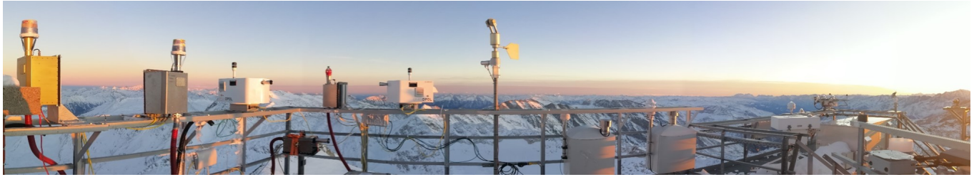
Abb.1: Beitrag von NF CIS SBO zu CCPar. Verschiedene Spektrometer zur Erfassung von Wolkenpartikeln und Spektren. Z.B. Fogmonitor (DMT), GFAS-DPOL (DMT), wie auch CDA (Palas GmbH). Aufnahme zeigt Messaufbau während der Vergleichsmesskampagnen ECCINT-INT01. Mittig befindet sich das holographische Prototyp ICEMET (Uni Oulu). Der Betrieb von Spektrometern im Hochgebirge ist herausfordernd..
