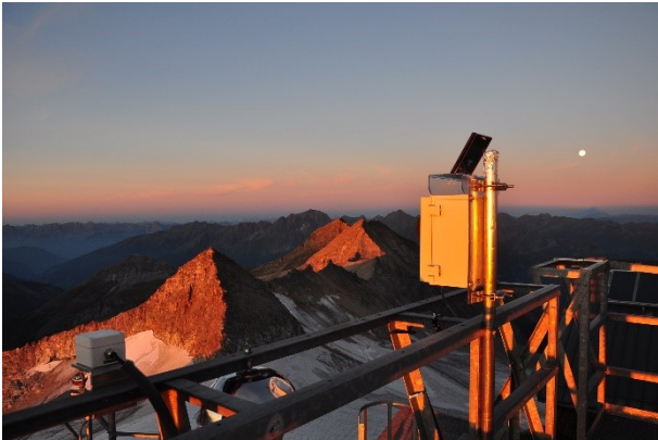
Abb.1: Der Batcorder zeichnet automatisch Ultraschallrufe von Fledermäusen auf Fig.1: The Batcorder: automated recording of ultrasonic bat calls
