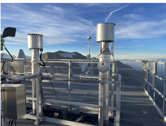
Abb.1: Aerosol-Monitoring am SBO. Links: Aerosoleinlässe, mit dem GAW- und ACTRIS NF AIS-Einlass auf der rechten Seite. Der linke Einlass ist für zusätzliche Messungen und Experimente vorgesehen. Rechts: Aerosol-Labor des SBOs. Das GAW- und ACTRIS NF AIS-Rack ist links. Das rechte Gestell wird für Experimente, vergleichende Messungen und ACTRIS NF CIS INP-Messungen verwendet.
