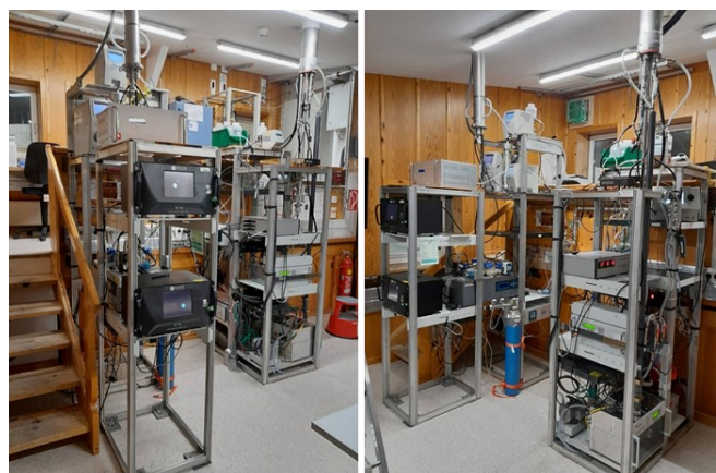
Abb.1: Aerosol-Monitoring am SBO. Links: Aerosoleinlässe, mit dem GAW- und ACTRIS NF AIS-Einlass auf der rechten Seite. Der linke Einlass ist für zusätzliche Messungen und Experimente vorgesehen. Rechts: Aerosol-Labor des SBOs. Das GAW- und ACTRIS NF AIS-Rack ist links. Das rechte Gestell wird für Experimente, vergleichende Messungen und ACTRIS NF CIS INP-Messungen verwendet.
