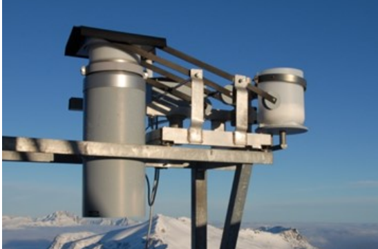
Abb.1: WADOS – Niederschlagssammler am Sonnblick Fig.1: WADOS – Wet and Dry Only Sampler at Sonnblick Quelle/Source: G. Schauer
