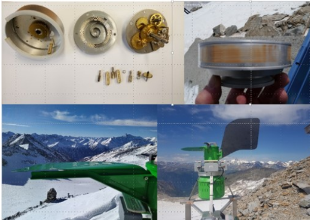
Abb.1: Uhrwerk der Pollenfalle zerlegt, Saharastaub auf der Trommel, die umgeknickte und reparierte Windfahne
