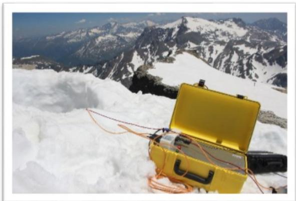
Abb.1: Messungen der hochfrequenten Induzierten Polarisation auf dem Hohen Sonnblick; Messgerät Chameleon I (Radic Research).
