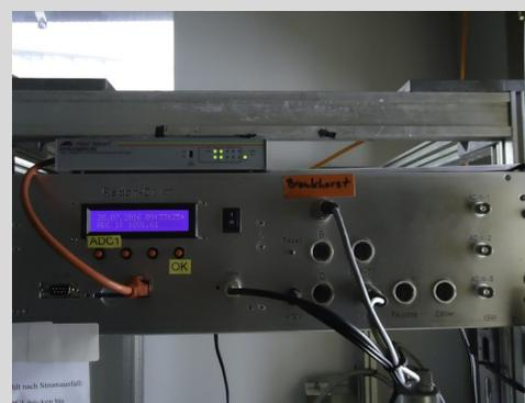
Abb.2: Radon-Monitor der Universität Heidelberg am Sonnblick Observatorium
