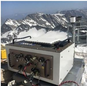
Abb.1: Geophysikalisches Messsystem zur Bestimmung der komplexen Leitfähigkeit im Untergrund des Gipfelbereichs des Hohen Sonnblicks.
