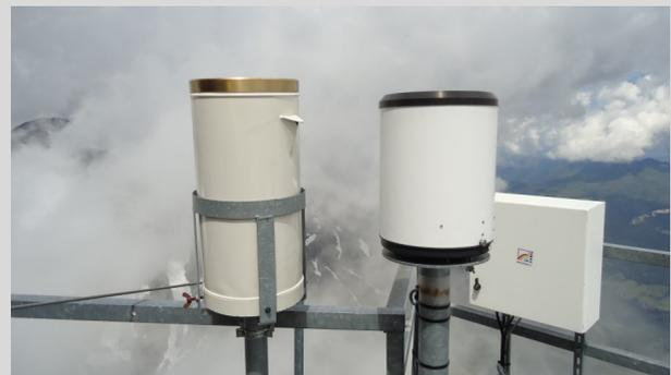
Abb.2: Niederschlagssammlung und Messung auf der nördlichen Messplattform des Sonnblick Observatoriums. Foto von H. Scheer.
