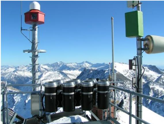
Abb.1: Probensammelgeräte für persistente Schadstoffe am Hohen Sonnblick
