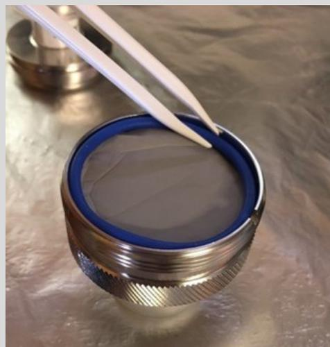
Abb.2: Filter im Filtergehäuse
