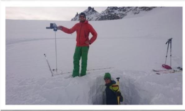
Abb.1: Erhebung eines Schneeprofiles am Goldbergkees
