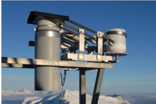
Abb.1: Sammler zur Schnee-probenahme - WADOS (Wet And Dry Only Sampler)
