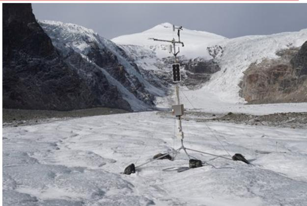
Abb.1: Automatische Energie- und Massenbilanzstation auf der Pasterze
