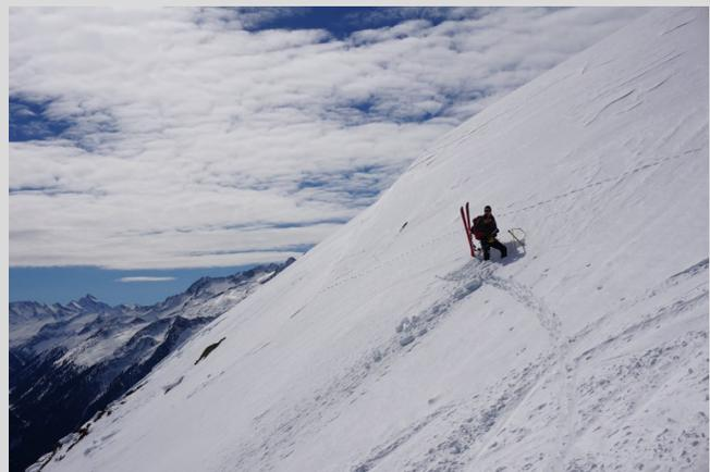
Abb.2: Lawinenbeobachter beim Erstellen von Schneeprofile und Stabilitätstests
