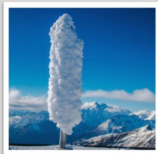
Abb.2: Eislastmessung am IceMonitor™.
