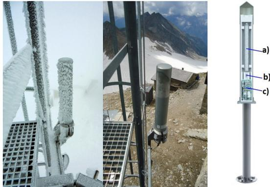
Abb.1: Links: Sonde-Ortsdosisleistung am Sonnblick Observatorium. Rechts: Schema der Sonde mit a) Niederdosiszählrohr, b) Hochdosiszählrohr, c) Auswerteelektronik.
