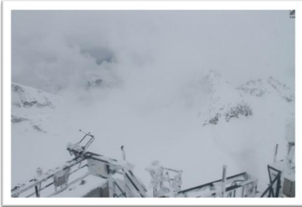
Abb.1: Automatische Eislastmessung mit allseitigem Eisansatz im November 2018.
