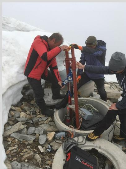
Abb.2: Wartung der Permafrostmessketten in den 20m Bohrlöchern am Hohen Sonnblick im Rahmen von ASBO.
