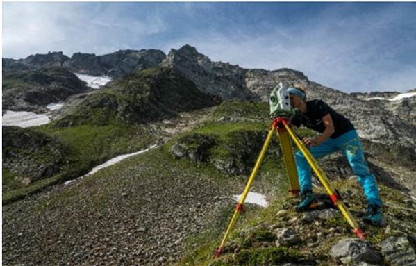
Abb.1: Referenzierung der Bodenkontrollpunkte im Vorfeld der UAS-Befliegung
