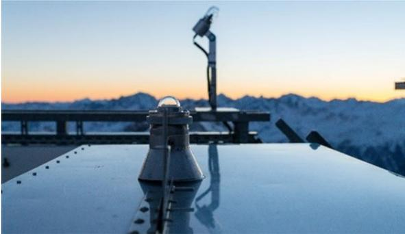
Abb.1: Das Bentham Spektralradiometer auf der Südterrasse des Observatoriums.
