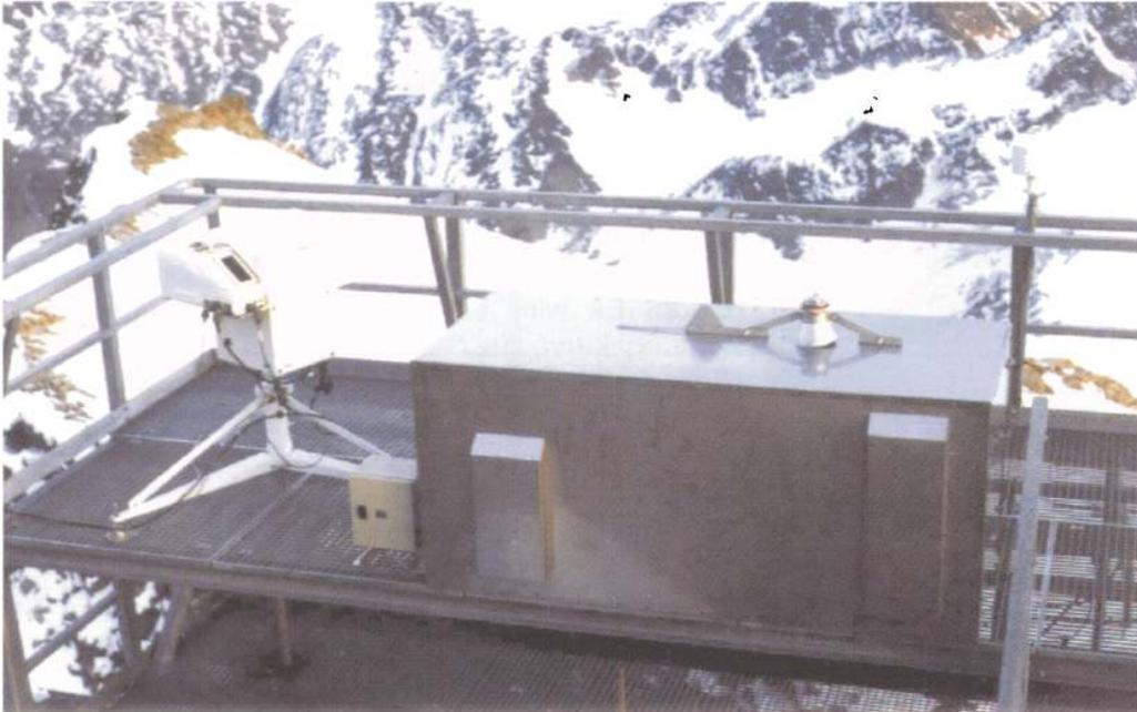
Zur Aufnahme wissenschaftlich aussagekräftiger Spektren der UV-Strahlung wird am Hohen Sonnblick seit 1996 das Bentham-Spektrophotometer eingesetzt. Die Auflösung des Spektrums mittels dieses Gerätes erfolgt so präzise, daß sie für eine Gewichtung mit bekannten Wirkungskurven biologischer Vorgänge verwendet werden kann.
