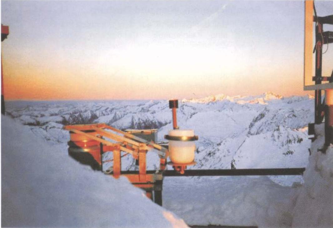
Die Niederschlagschemie ist die Quantifizierung der „Sauren Regen“-Problematik. Die Analyse von Regeninhaltsstoffen und chemisch-physikalischen Parametern (Leitfähigkeit, pH-Wert) lassen eine präzise Aussage über den Zustand des Niederschlages zu. Die großen Unterschiede in der Zusammensetzung der nassen (Regen, Schnee,...) und der trockenen Deposition (Staub, reaktive Gase.) machen eine Abtrennung der unterschiedlichen Niederschlagsarten unausweichlich.
