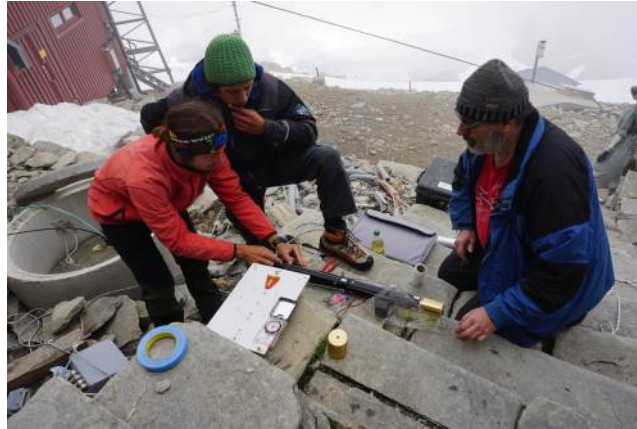
Steinschlag-Messungen in den Hohen Tauern: Vorbereitung des seismischen Messgeräts für die Montage im Bohrloch beim Sonnblick-Observatorium. Quelle ZAMG/Binder.
