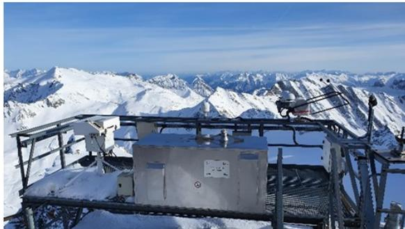
Abb.1: Inge Dirmhirn UV-Messstation am SBO mit Bentham Spektralradiometer im Vordergrund und Brewer Spektrophotometer im Hintergrund.
