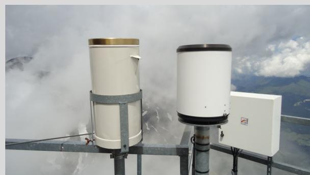
Abb.2: Niederschlagssammlung und Messung auf der nördlichen Messplattform des Sonnblick Observatoriums. Foto von H. Scheer.
