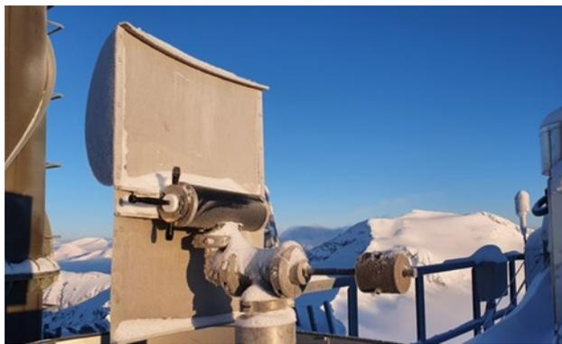
Abb.1: Probenahme von Wolkenwasser mit einem einstufigen Impaktor
