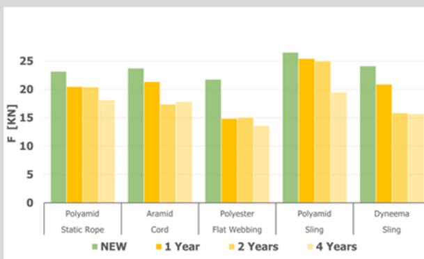
Abb.1: Maximale Bruchlast im Zugversuch
