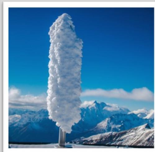
Abb.2: Eislastmessung am IceMonitor™.
