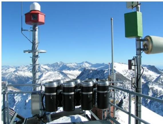
Abb.1: Probensammelgeräte für persistente Schadstoffe am Hohen Sonnblick
