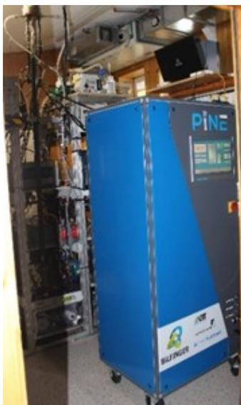
Abb.1: Online INP Messgerät PINE im Aerosolraum des SBO
