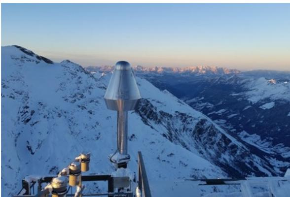
Abb.1: Zentrale Ansaugung für Spurengasmessungen
