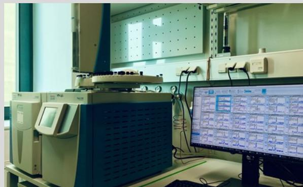
Abb.2: Analysengerät – GC-MS/MS
