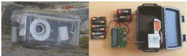
Abbildung 1: Automatisches Kamerasystem entwickelt von G. Weyss, am Fels montiert und zerlegt. Materialkosten ca. 250€.
