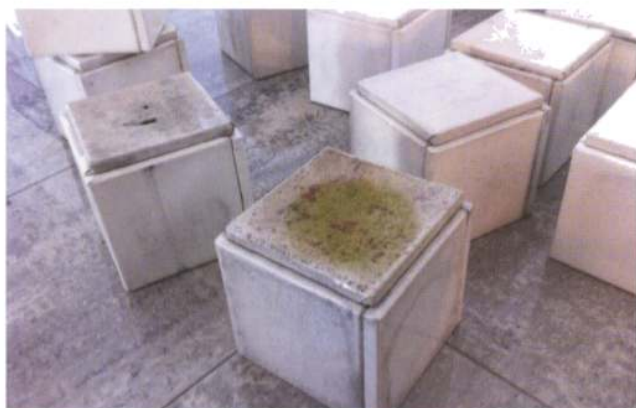
Bild 1: Die unterschiedlichen Verfärbungen nach einem Jahr Auswitterung
