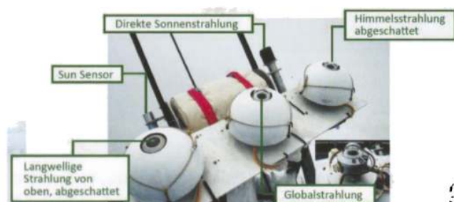
Abbildung 1: ARAD/BSRN Station Sonnblick: Sonnenfolger mit den verschiedenen Strahlungsmessgeräten.
