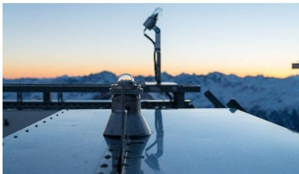
Abb.1: Das Bentham Spektラルradiometer am Hohen Sonnblick (3106 m).
