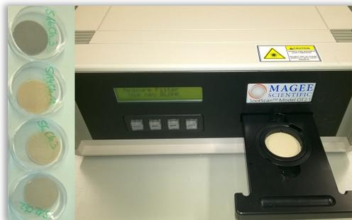
Abb.1: Beprobte Filter vom Sonnblick und SootScan™ OT21 Transmissometer
