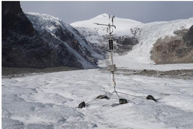
Abb.1: Automatische Wetter- und Massenbilanzstation auf der Pasterze.
