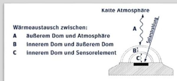
Abb.1: Darstellung der durch Temperaturdifferenzen hervorgerufene Wärmeströme im Messgerät
