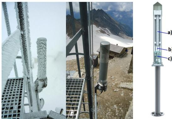
Abb.1: Links: Sonde-Ortsdosisleistung am Sonnblick Observatorium. Rechts: Schema der Sonde mit a) Niederdosiszählrohr, b) Hochdosiszählrohr, c) Auswertelektronik. Fig.1: Left: Sensor-local dose rate at Sonnblick Observatory. Right: Scheme of the sensor with a Geiger counter für a) low dose rate, b) high dose rate, c) evaluation electronic.
