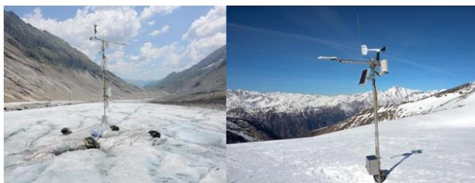
Abbildung 1: Automatische Energiebilanz- und Massenbilanzmessstationen auf der Pasterze (links) und am Kleinfleißkees (rechts).
