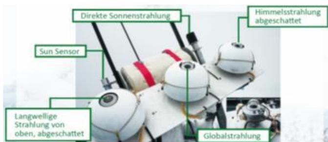
Abbildung 1: ARAD/BSRN Station Sonnblick: Sonnenfolger mit den verschiedenen Strahlungsmessgeräten.
