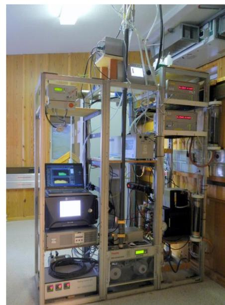
Abbildung 2: Aerosolmessplatz am Sonnblick Observatorium
