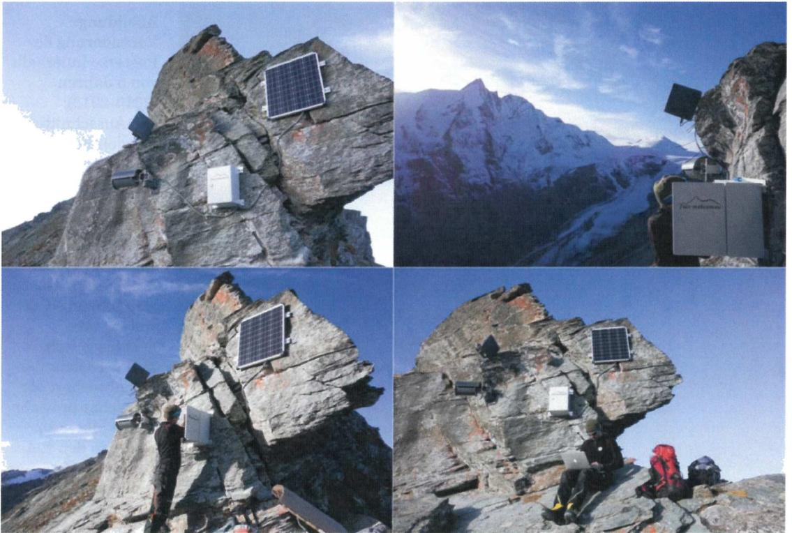
Abbildungen: Oben: Die autarke Webcam am Freiwanddeck (Pasterze) bestehend aus Solarpanel, Richtfunkantenne, Kameragehäuse mit Kamera und Steuerung und Schaltschrank mit Laderegler und Akku. Unten: Georeferenzierung von Gegenhangfotos der Webcam am Kleinfleißkees und Oberflächenklassifikation in die Klassen Schnee/ Firn/ Eis vom Sommer 2015. Ergebnisse aus der Masterarbeit von I. Rojs (2016) unter Verwendung der matlab-Software practise (Härer et al., 2016).
