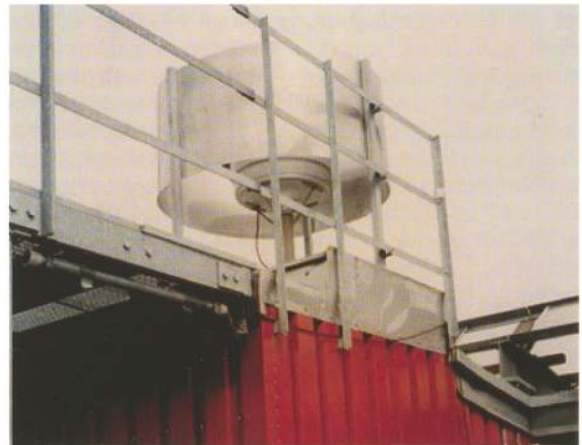
Abb. 2: Ansaugkopf des Aerosolsammlers
