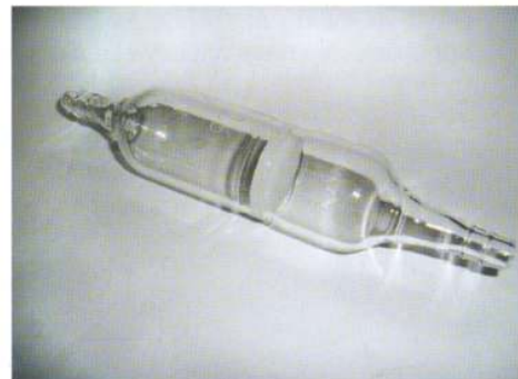
Abb. 2: Sammeleinheit für die NO 2 Messungen
