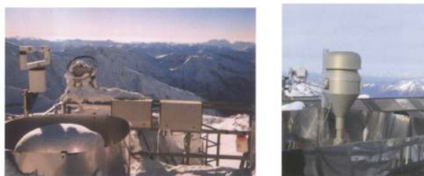
Abb. 3: Filterstacksammler (inline) und HiVolume Sammler
