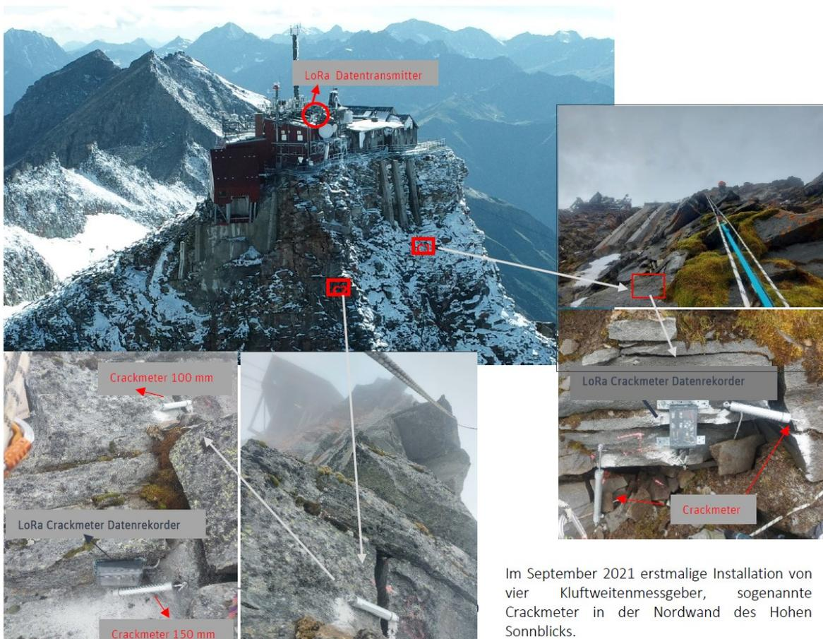
Im September 2021 erstmalige Installation von vier Kluftweitenmessgeber, sogenannte Crackmeter in der Nordwand des Hohen Sonnblicks.
