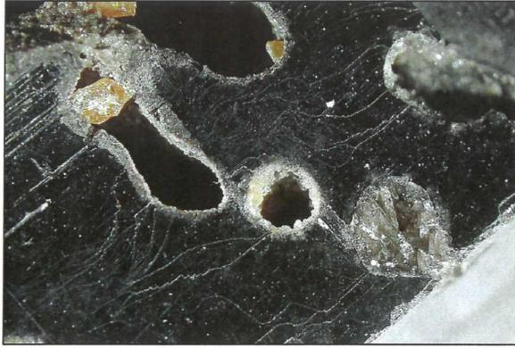
Abb. 3: Bruchstück eines Galenitkristalles vom Windischkopf, Salzburg mit deutlich erkennbaren Korrosionskanälen, die mit Cerussit (weiß) und Wulfenit (gelborange) teilweise gefüllt sind. Bildbreite 2 cm.
